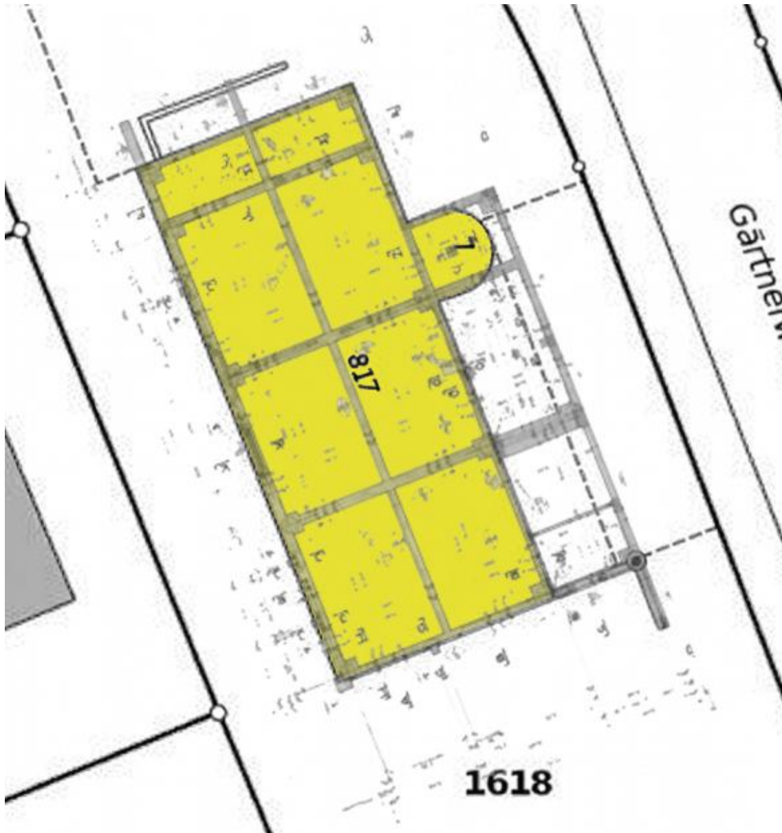
Stahlbetonrost überlagert mit Gebäudegrundriss aus amtlicher Vermessung
